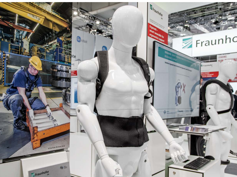
ErgoJack gibt es in verschiedenen Designvarianten. Auf der Hannover Messe wurden eine rein sensorische Textilweste (links) und eine Leichtbauweste, die Kräfte aus dem Oberkörper über Federelemente in die Beine ableitet (rechts), gezeigt.
