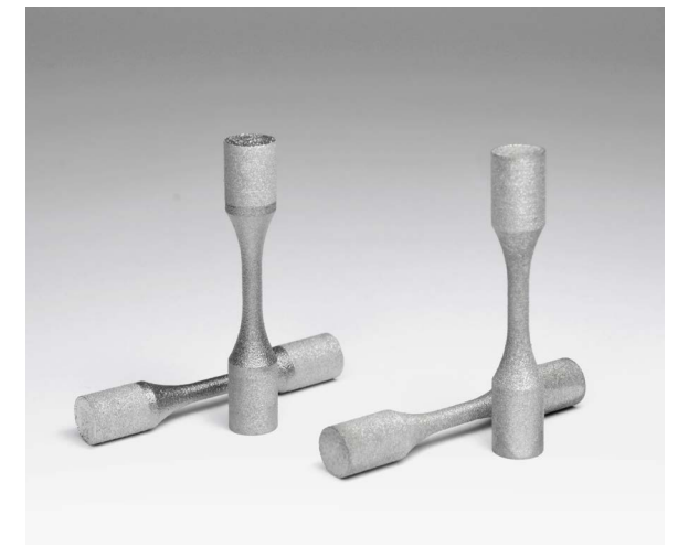
Mit SLM hergestellte Proben zur mechanischen Charakterisierung von Titanlegierungsbauteilen
